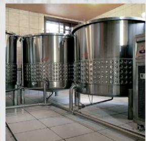
Fermentação feita em tanques inoxidáveis com total controle de temperatura. Fermentation in stainless steel tanks with absolute temperature control.
